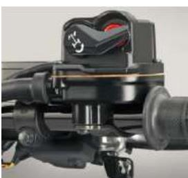
El TRX520 Cuenta con el sistema TraxLok para acoplar la tracción delantera de manera electrónica, presionando un botón.
