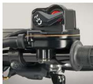
El TRX520 Cuenta con el sistema TraxLok para acoplar la tracción delantera de manera electrónica, presionando un botón. Se tienen 3 modos de conducción :
