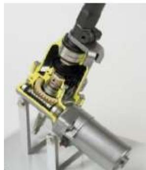
Sensible a la velocidad y al torque, el sistema de dirección asistida (EPS) mejora ampliamente la reducción del esfuerzo que requiere el piloto durante la conducción. El EPS es muy útil cuando se conduce sobre caminos rocosos, accidentados o arenosos. También es muy útil al conducir en modo 4x4, ya que reduce notoriamente el esfuerzo que se requiere para maniobrar y mejora la sensación de control de la unidad.
